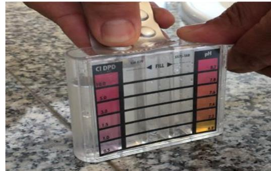
5. Comparar cada celda de prueba con su respectiva escala colorimétrica colocando un fondo blanco por detrás para poder observar el color que presenta el agua, y registrar el resultado.
