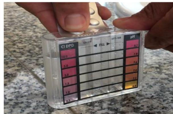
5. Comparar cada celda de prueba con su respectiva escala colorimétrica colocando un fondo blanco por detrás para observar el color que presenta el agua, y registrar el resultado.
